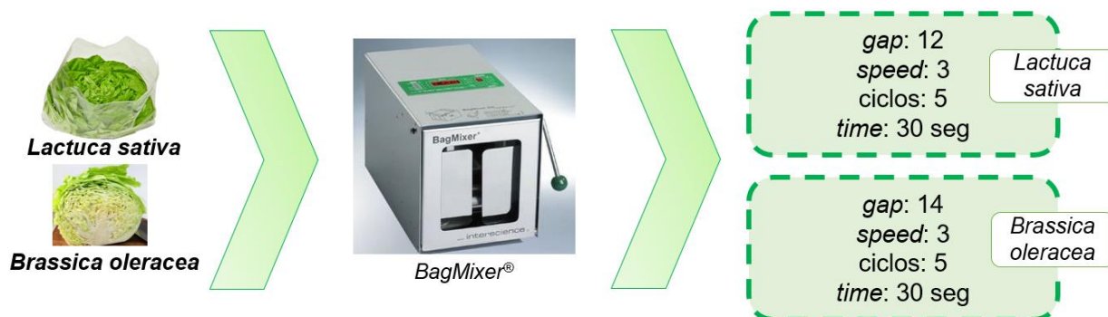
Figura 5. Esquema general del método de recuperación de ooquistes de Cyclospora cayetanensis en muestras vegetales (lechuga y repollo).
