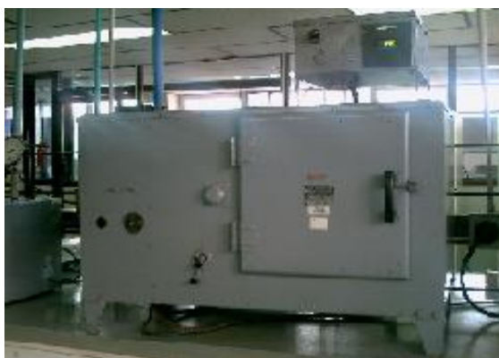
Fig. 35. Estufa eléctrica de aire circundante
