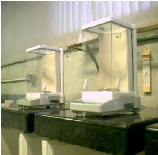
Fig. 2 Mesas anti vibratorias para balanza analítica
