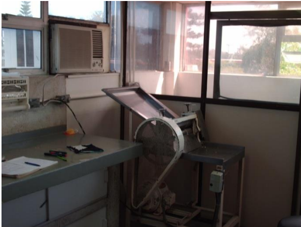
Fig. 6 Cilindro de panadería
