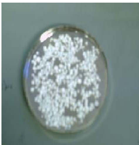
Fig. 39 Urea después del secado en el halógeno
