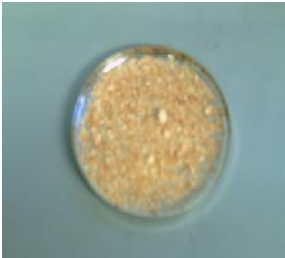
Fig. 38 Torta de soya después del secado en el halógeno
