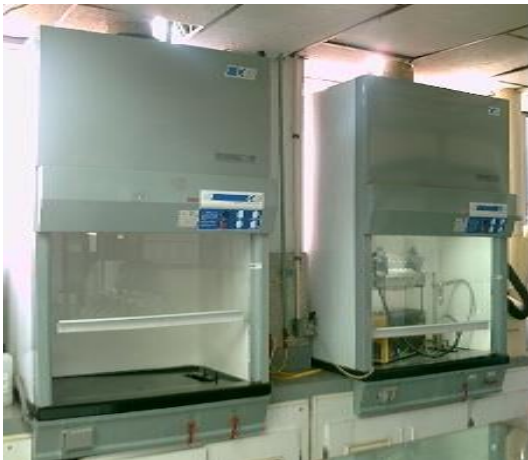
Fig. 16 Campanas de extracción
