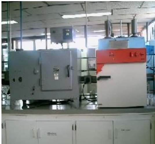
Fig. 8 y 9. Estufas de 100 °C y 130 °C
