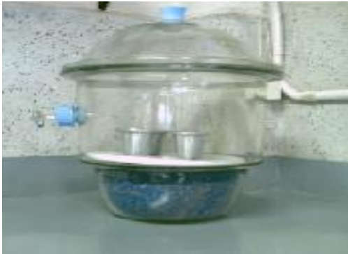
Fig. 36 Desecador de muestras
