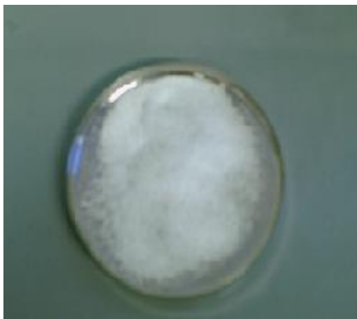
Fig. 40. Sal refisal después del secado en halógeno
