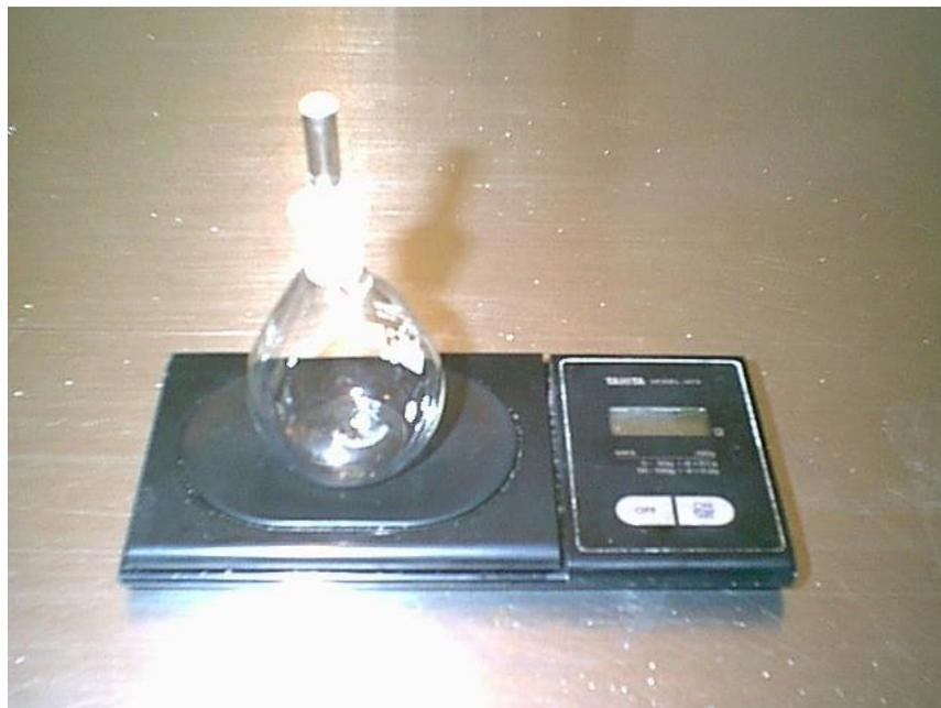
FIGURA 6(a). Montaje para la calibración del picnómetro
