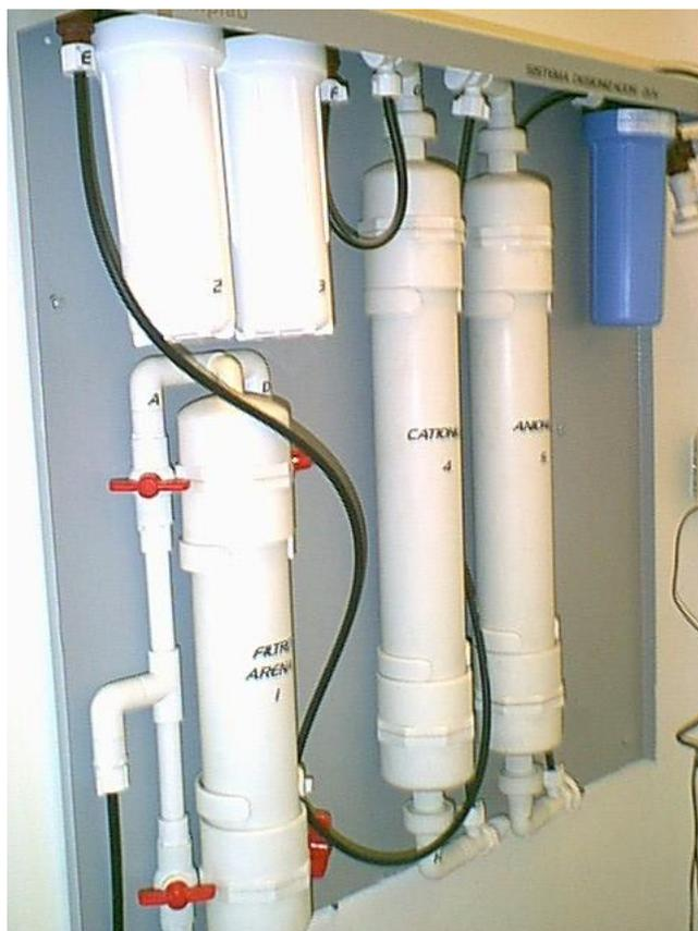
FIGURA 3. Desmineralizador
