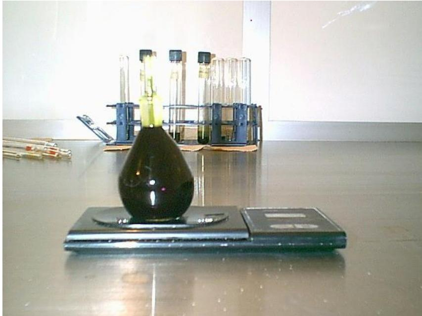
FIGURA 6(b). Montaje para la determinación de la Densidad
