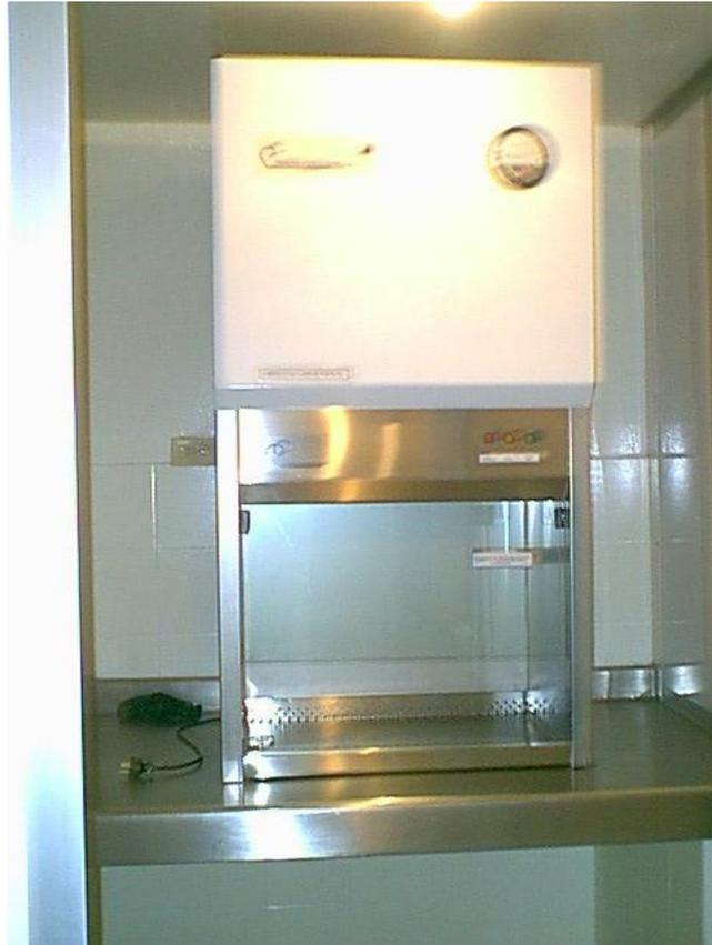
FIGURA 9. Cabina de flujo laminar vertical
