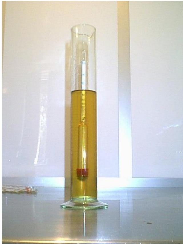
FIGURA 5. Montaje para la determinación del Grado Alcohólico
