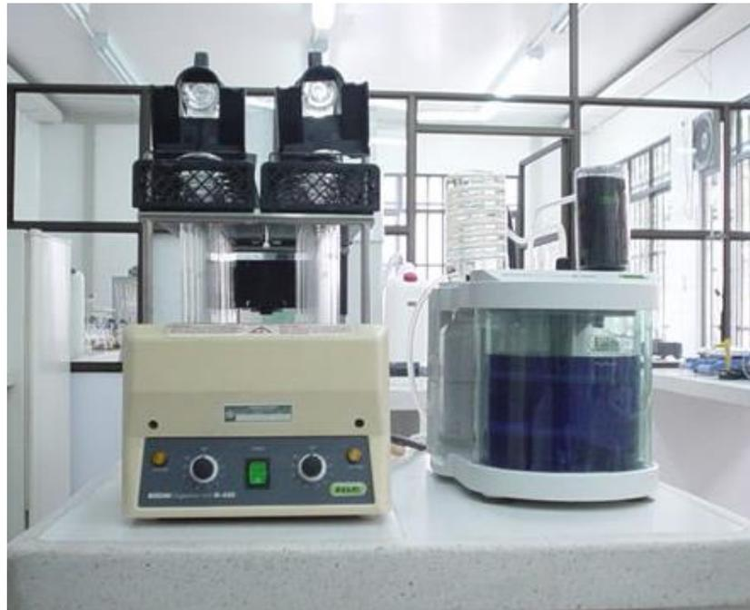
Foto IV. Digestor de Kjeldahl
