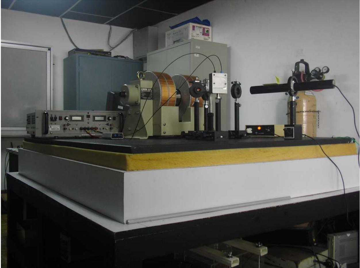
**3. POSICIONADOR DISEÑADO DENTRO DEL PROYECTO E INTERFAZ PARA EL CONTROL AUTOMÁTICO**
