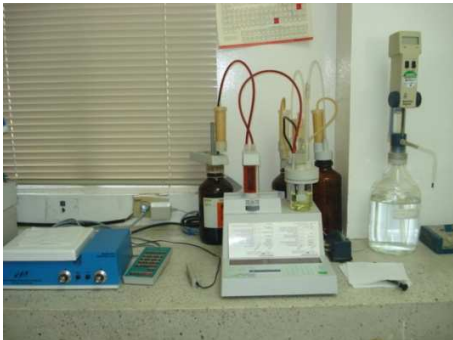
Análisis de Humedad del Alcohol
