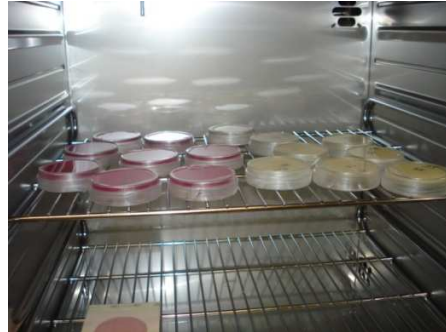
Incubación a 35°C Mesófilos y Coliformes
