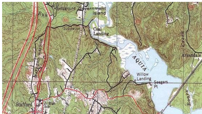
Fig. 3 Los mapas topográficos permiten conocer la topografía del terreno a través de sombreados, curvas de nivel u otros sistemas de representación gráfica.
