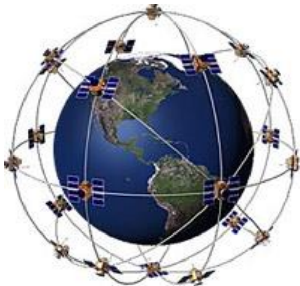
Fig. No 9 Constelación GPS en órbita
