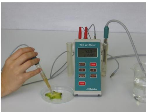
Figura 14. pH metro de penetración Metrohm 6.0226. 100pH 4 – 9/0-40°C
