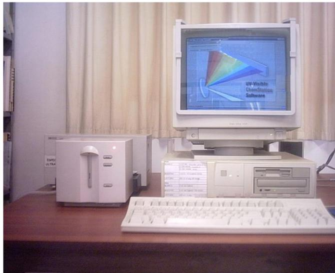
Figura 23. Espectrofotómetro ultravioleta-visible (UV-VIS) con arreglo de diodos Hewlett Packard modelo HP-8453
