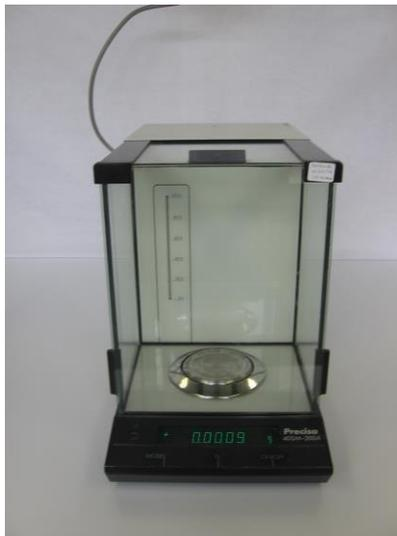
Figura 9. Balanza Analítica Precisa modelo 40 SM-200<sup>a</sup>
