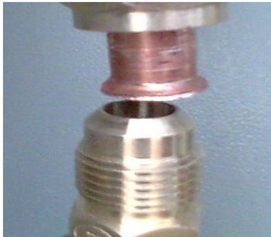
**2.2.2.1** Elaboración del bocín. Para tal propósito existe un kit de herramienta compuesto por un cortatubo de rodaja, una prensa pequeña y un abocinador.
