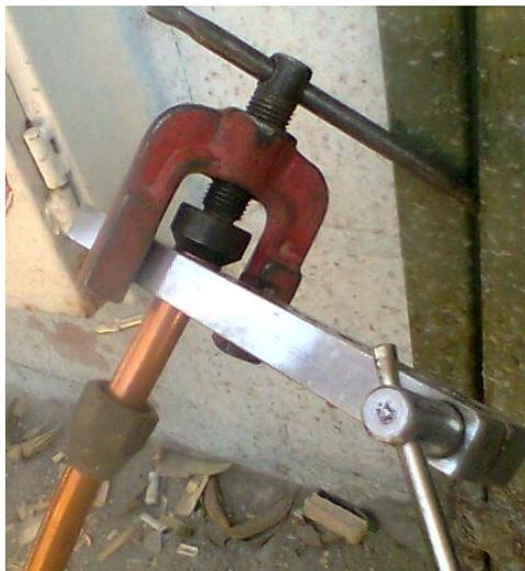
El bocín debe tener un tamaño acorde a la superficie del accesorio que va a cubrir; no debe ser muy pequeño ni muy grande. Al momento de realizar la unión se puede usar sellante líquido directamente en las superficies cóncava y convexa, aunque en éste sistema puede lograrse la hermeticidad sin necesidad de sellante.
