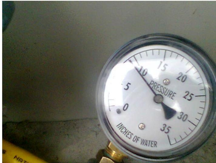
Con el mismo caudal de salida se toma la presión dinámica en la salida del medidor equivalente a 9.0 "WC (22.41 mbar).
