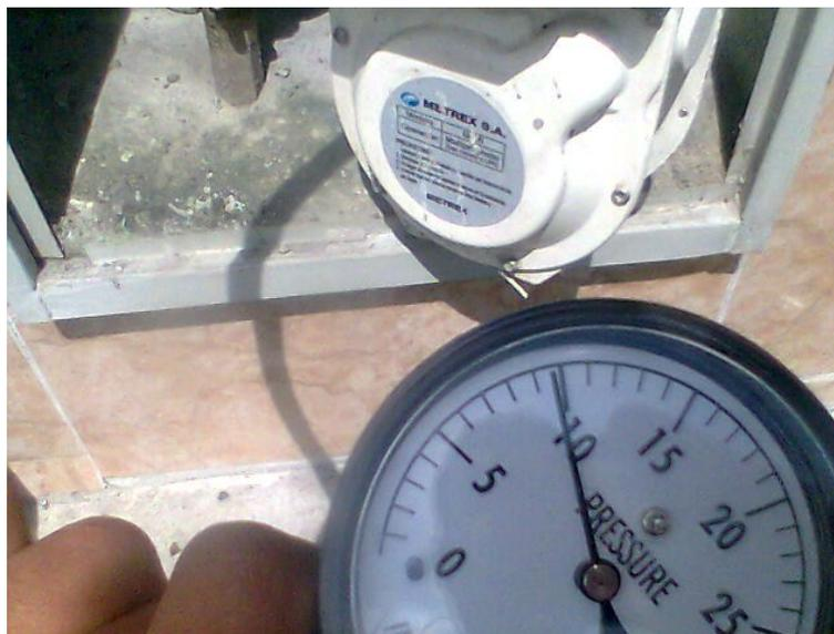
Luego con un caudal de salida bajo (equivalente a un quemador residencial) se toma la presión dinámica antes del medidor (salida del regulador). El resultado 9.2 "WC (22.91 mbar).
