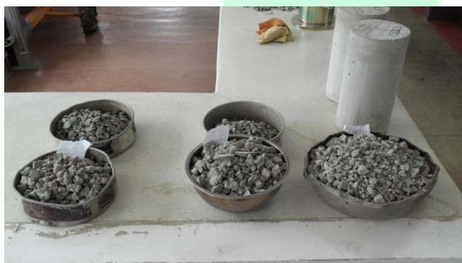
Tomada por: José Luis Rojas y Julián Berrio M Material grueso reciclado lavado, secado y listo para prueba de desgaste
