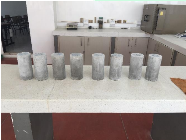
Tomada por: José Luis Rojas y Julián Berrio M Cilindros de concreto listos para ensayo de compresión
