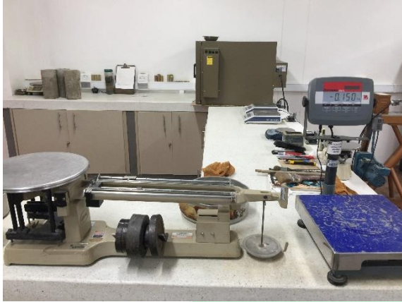
Tomada por: José Luis Rojas y Julián Berrío M Equipos de laboratorio horno, balanza, balanza digital
