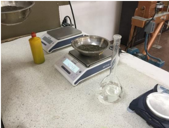
Tomada por: José Luis Rojas y Julián Berrio M Balanza digital, con matraz y dosificador de agua
