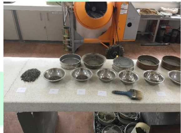
Tomada por: José Luis Rojas y Julián Berrio M Apreciación de la granulometría con sus tamices
