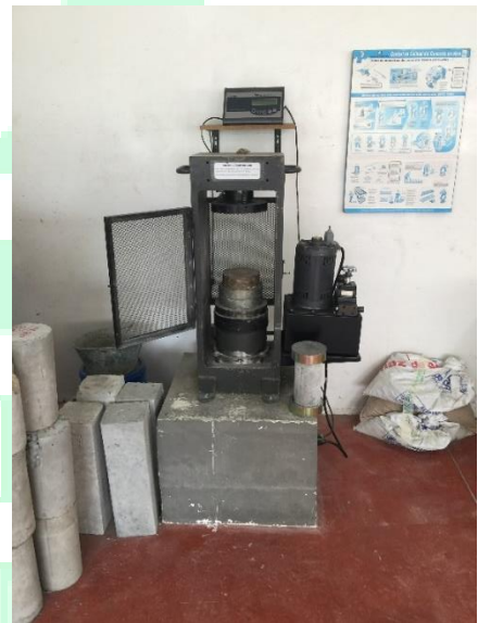
Tomada por: José Luis Rojas y Julián Berrio M Prensa hidráulica para ensayo de compresión
