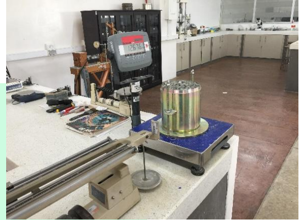
Tomada por: José Luis Rojas y Julián Berrío M Se pesa el recipiente + la grava para determinar densidad específica
