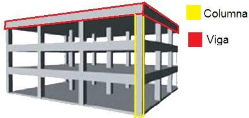
Figura. Sistema aporricado convencional en concreto
